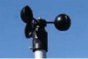
5.1 Las grúas torre deben estar equipadas con un anemómetro, excepto en el caso de las grúas torre automontantes cuya altura bajo gancho sea inferior a 30m.
