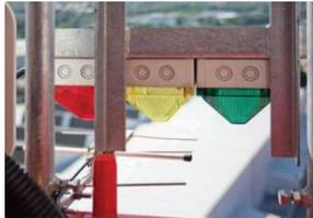
5.3 En el caso de que las grúas torre funcionen con mando por radio se instalarán indicadores luminosos exteriores con el objetivo de informar de las condiciones de trabajo de la grúa. Una luz verde se situará de forma que pueda ser vista por las personas próximas a la grúa.
