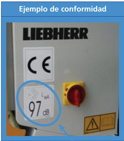
El nivel de potencia acústica aparece impreso en pegatinas que generalmente se colocan tanto en la parte inferior como en la parte superior de la grúa.
